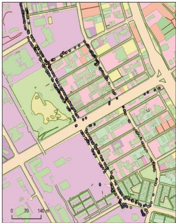
図 1 つくば市の歩道における破損の程度
