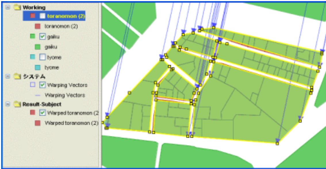
図5.23-6 リンクを増やしたラバーシート後
