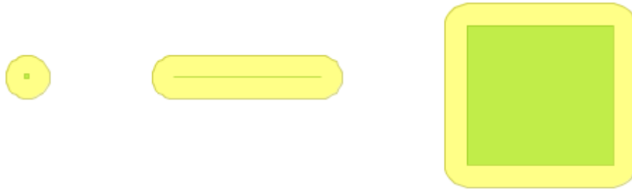
図5.9-14a 終端スタイル“Round”の例(左から, ポイント, ライン, ポリゴン)
